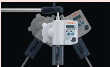
ノブ1つで本体角度を調節でき、可動範囲の大きなボール径のフリークランプ機構を採用。安定した保持力を持ち、攪拌シール、攪拌棒、フラスコなどのセンター合せも容易です。
