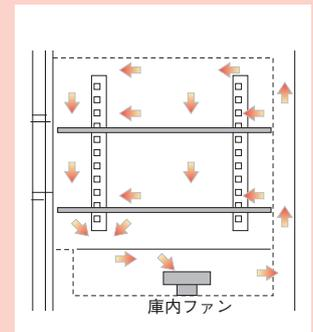
庫内の対流は、上から下方向に対流だけでなく背面から並行に対流するので、上から下方向だけの対流に比べ温度ムラを抑えられます。棚板はパンチング孔なので、試験管立てなど脚が細い物や棚板との接触面積が極めて小さいものの設置が可能です。
