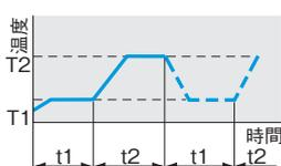
2つの温度と時間を設定し繰返す回数を設定します。設定温度T1にて時間t1経過後、設定温度T2にて時間t2まで温度制御を行ないます。この動作を繰返す回数分ない温度制御を停止します。
