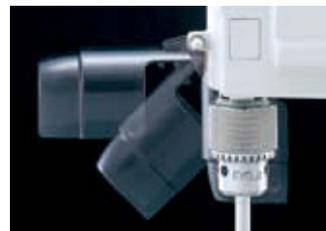
エアパージ口によりエアーを攪拌機本体内に供給することができ、外部からの溶媒、酸の浸入を防ぎます。回転中のドリルチャックによる髪などの巻込みを防止するためにチャックカバーを設けました。(PAT.)
