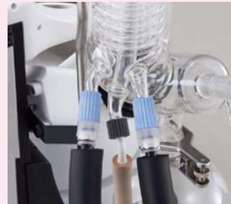
オプションのワンタッチコネクタとワンタッチ保冷ホースセットの使用により冷却器と保冷ホースの着脱が簡単にこなえます。
