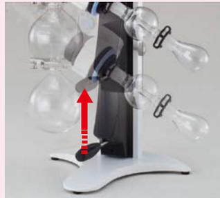
ジャッキは無段階で調節ができます。試料容器に合わせて任意の位置で固定ができます。トラップ球を使用する際にも操作しやすくなっています。
