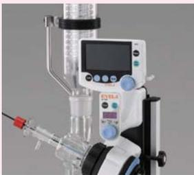
真空コントローラーNVC-3000型、溶媒回収ユニットDPE-1150・2150型、DPE-1250B・C・D・E型と接続することで圧力コントロールと同時にロータリーエバポレーターの回転数やバス温度・冷却水温度などの測定値の表示や設定変更(バスは除く)ができます。(P.203参照)
