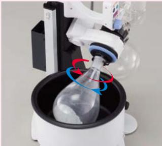
フラスコの回転方向(正転・逆転)の設定が可能です。自動反転も可能で、粉体などの乾燥や固形物を含むサンプルの乾燥・濃縮に有効です。
