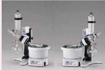
ガラスセットを装置の左右どちらでも取付け可能です。セッティング時に実験台のスペースや利き手を考慮して装置を設置することができます。
