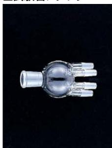
小型ロータリーエバポレーターに試験管6本を取付けるためのアダプターです。少量試料の濃縮や、ドーピング検査に適しています。
