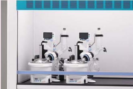
E型ガラスセットはドラフトチャンバー内の使用を考慮し、縦型冷却器の特性を活かしたコンパクト設計です。キャピラリーからの逆流の心配がない構造でペーパーを効率的に回収できる冷却器です。
