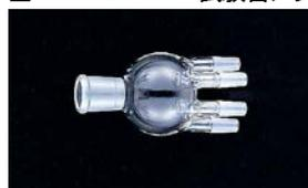
アイラコートされた試験管アダプターです。試験管を6本取付け、少量試料の濃縮や、ドレーピング検査に適しています。
