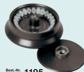
Best.-Nr. Cat.-No. 1195 n = 18.000 min -1 , RCF 31.514 aerosoldicht /aerosol-tight 3)
